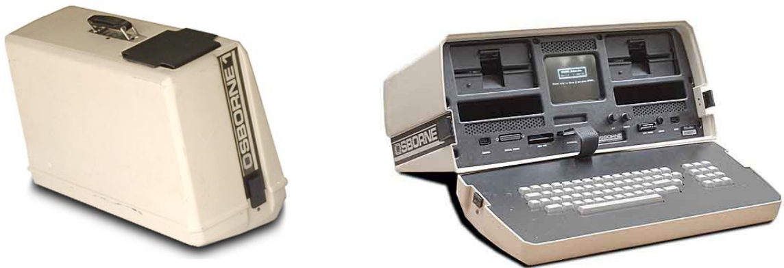
ตัวอย่างเครื่องคอมพิวเตอร์หิ้วถือ ออสบอร์น หน้าหนัก 24.5 ปอนด์ แต่สามารถใส่ได้เก้าอี้เครื่องบินได้
